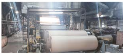
Итак, однородная масса — пульпа, поступает по трубам в цех по производству бумаги и картона. Здесь бумажная масса равномерно распределяется по специальной ленте, формирует полотно. Проходя через многочисленные вали и под воздействием температуры, которая достигает 120 градусов, полотно прошивается и наматывается на картонные шпулы. Получившиеся бобины, масса которых достигает 2 тонн, скрепляются лентами и проходят контрольные взвешивания.
