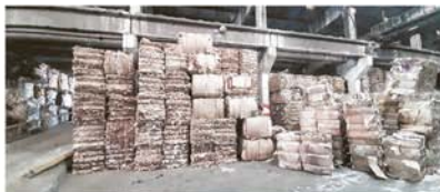
Холодный склад макулатуры (отправляет его нет смысла, поскольку использование бумаги часто имеет посылочный характер и в тепле может протухнуть). Ежедневно здесь разгружаются макулатурные вагоны. Предприятие покупает использованные коробки из-под продуктов и основную торговую сеть и производственных картонных коробок — они продают отходы (картона). Строительная и бытовая макулатура не подлежат использованию. Затем рабочие освобождают от элементов упаковки — скотча, металлических скрепок, синтетической трикотажной, проваляной прочего. Все это сортируется и также сдается на переработку другим производителям.
