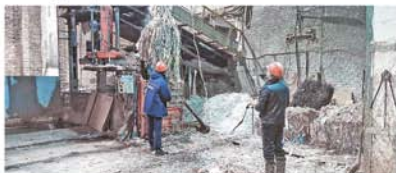
Затем коробки по транспортёрной ленте подаются в цикл самоподготовки для измельчения. Бумага попадает в гидроабразивный — резервуар с водой (ее температура 24-25 градусов по Цельсию). Гидроабразивная, оснащённая вращающимися устройствами и ножами, которые перемалывают и измельчают бумагу. Это придает ему свойства с кукурузным крахмалом или крахмалом. В результате измельченные частицы картона вместе с определенным количеством воды образуют кашеобразную массу — пульпу. Эта масса, проходя через специальный фильтр (стакане образом, остатки скотча и другой мусор отфильтровываются и также перерабатываются на переработку), попадает по трубе в картонный цех, где находится картонноделательная машина (КДМ). Оставшаяся вода очищается и вновь поступает в «бумажер».
